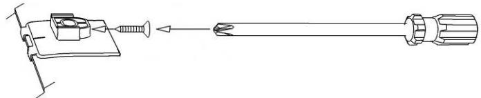
9. Insérer une vis à tête plate (5/8 po.) n° 6 dans chaque piédestal, puis la tourner en quelques mouvements. La pointe de la vis ne doit pas pénétrer dans le trou où l'épingle de fixation s'installera plus tard.
