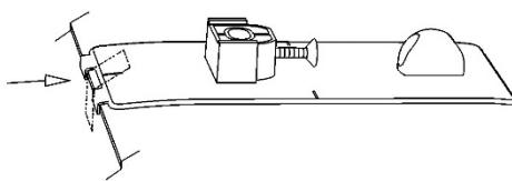
11. Poussez les supports de fixation métalliques sur le bord du capot, en les alignant avec les patins anti-abrasion installés précédemment. Assurez-vous que chaque support est bien en place sur le bord du capot et que son trou est aligné avec celui du socle. Aux emplacements indiqués.
