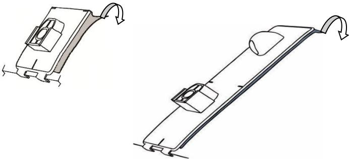
8. Un piédestal à la fois, retirer la pellicule protectrice de l'adhésif et installer sur la surface du capot.
