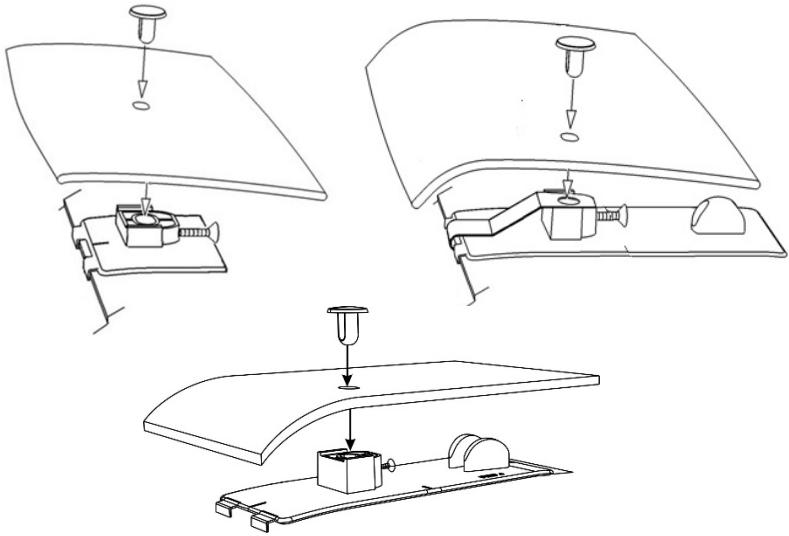
12. Placez le protecteur sur le piédestal et à partir de la position centrale installer une broche à travers le dispositif de protection et dans le socle. Maintenir une légère pression sur la goupille pour assurer un bon positionnement des composants, tout en serrant simultanément la vis de quelques tours. Répétez l'opération pour autres endroits sur pied.
