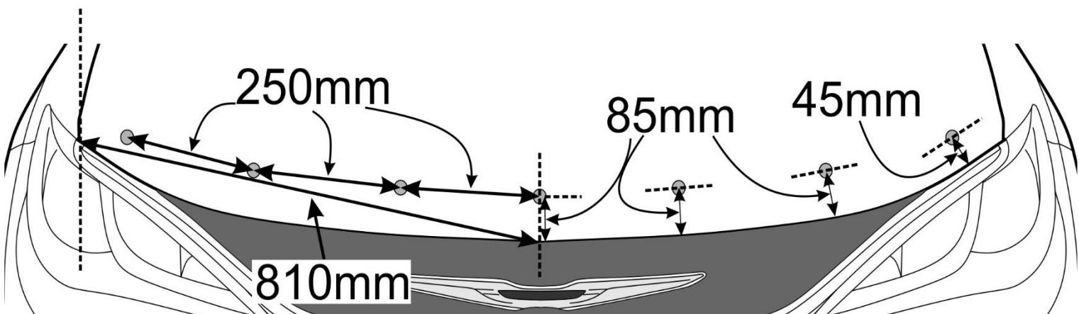
**ILLUSTRATION N°2 – CONFIGURATION DE LA FIXATION – N° DE BREVET : 6,892,427**
